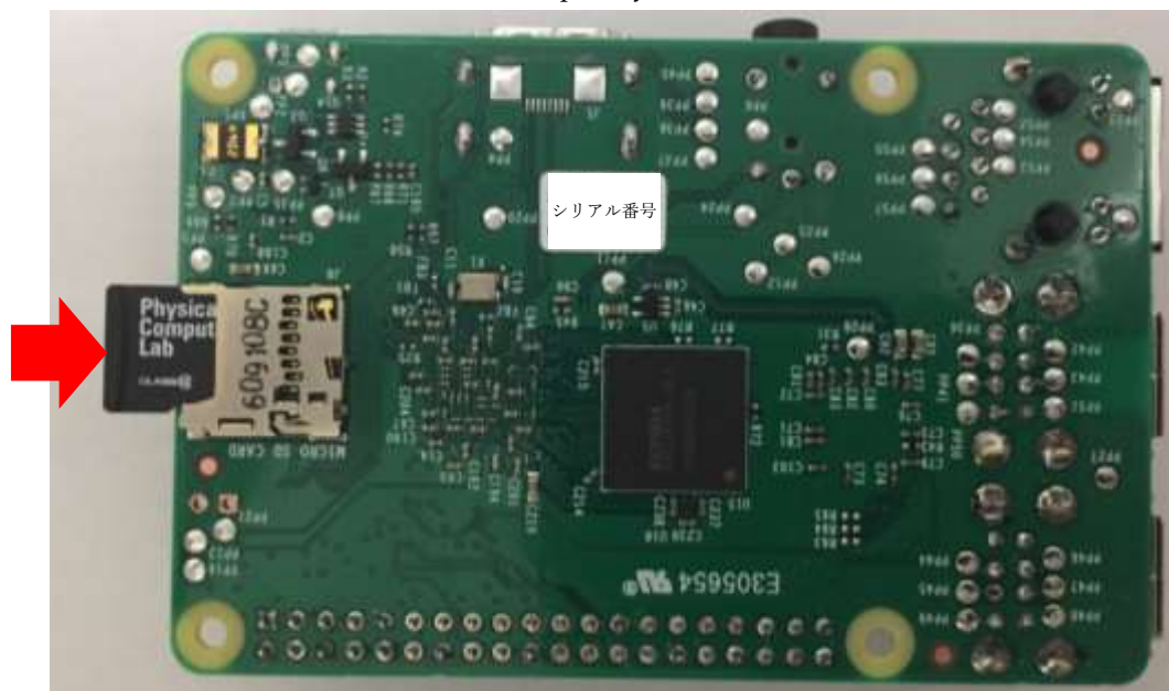
写真 1 : マイクロ SD カードを Raspberry Pi に差し込む
