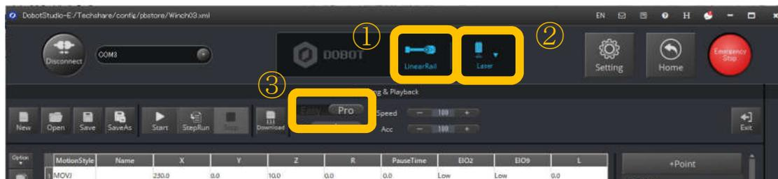
次に、Operation Panel の output ダイアログで使用したい IO ピンにチェックを入れます。その後+Point ボタンをクリックすると、チェックを入れた IO ピンの設定が可能な状態で座標のデータが現れます。
