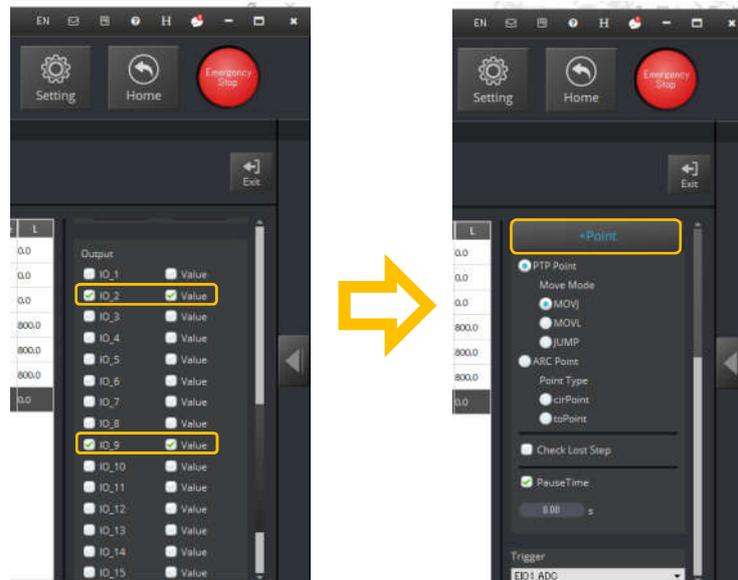
EIO の設定を High、または Low に設定することで状態を定義できます。デモファイルを実行すると、スライダレールの動作、および外部への信号出力が連動して動作することが確認できます。
