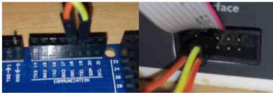
図 2.4 Dobot Magician と開発ボードの接続
