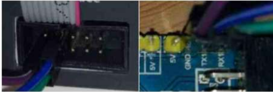
図 2.2 Dobot Magician と開発ボードの接続
