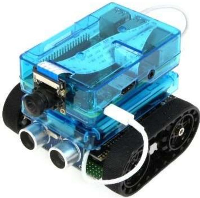
例 2 : Zumo に超音波センサーを取り付け、Raspberry Pi にカメラを取り付けた例
