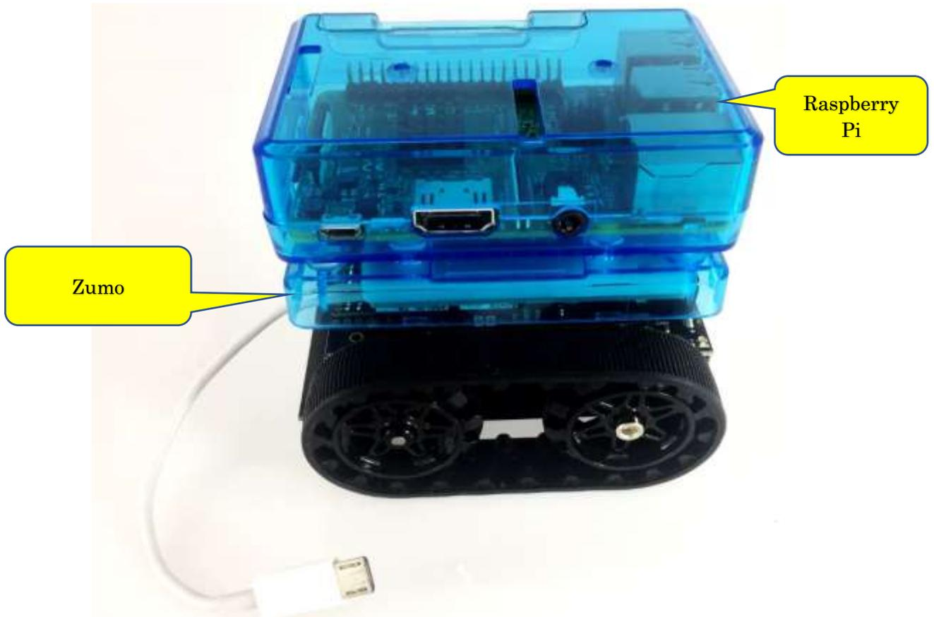
(3-4) Zumo 本体から出ている電源ケーブルを Raspberry Pi の電源口(マイクロ USB コネクタ)に挿入する。
