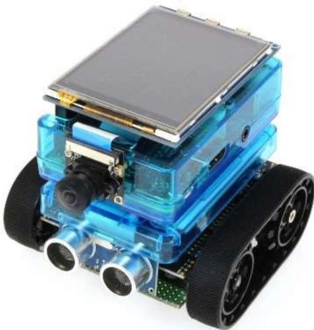
例 3 : さらにタッチパネル式 LCD を載せた例
